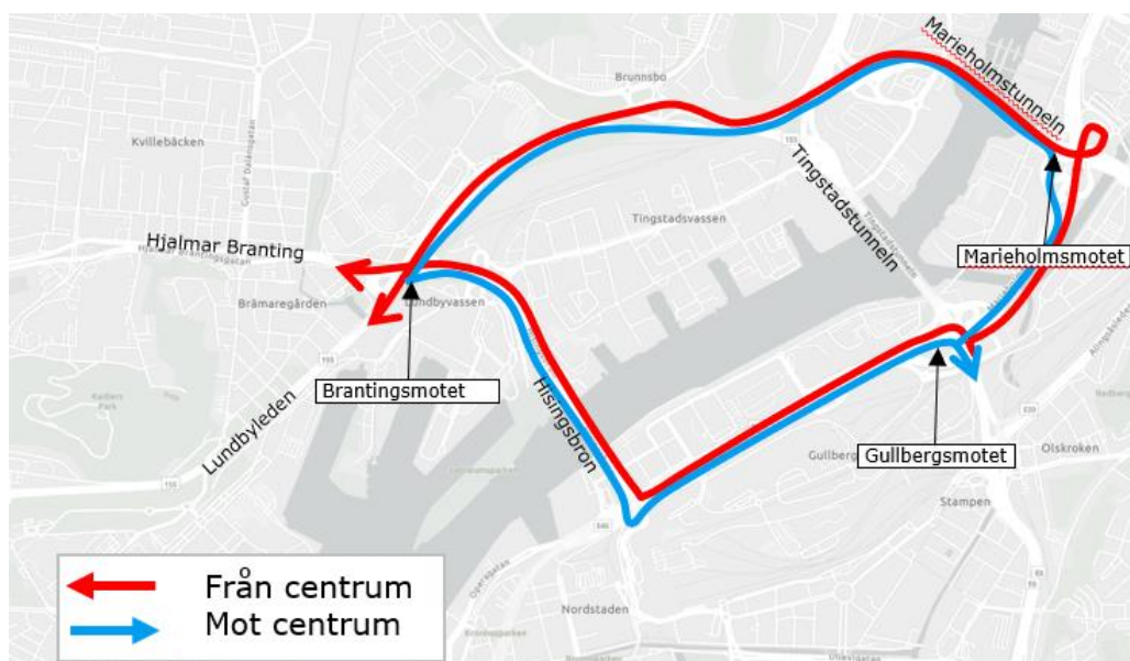
Figur 6 Alternativa ruttval för genomfartstrafik mellan Brantingsmotet och Gullbergsmotet under nuvarande trafiksituation, dvs när Tingstadstunneln är stängd mot Lundbyleden.
